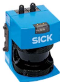
รูปที่ 2 อุปกรณ์วัดระยะทางเลเซอร์ที่ใช้ในงานวิจัย SICK LMS200 [34]
