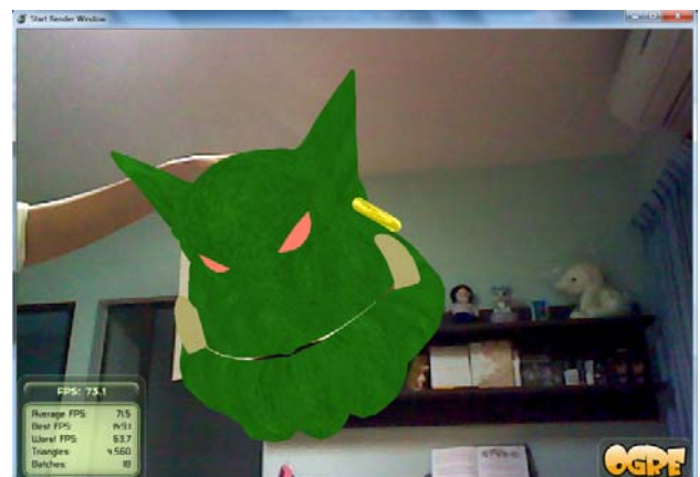
ภาพที่ 7.) แสดงการขึ้นรูปสามมิติบนมาร์คเกอร์ที่ตรวจจับพบ
