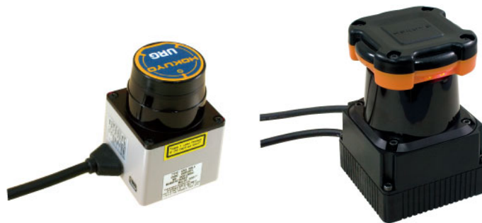
รูปที่ 2 แสดงอุปกรณ์วัดระยะทางด้วยเลเซอร์ที่ใช้ในงานวิจัย ซ้าย) Hokuyo URG-04, ขวา) Hokuyo UTM-30
